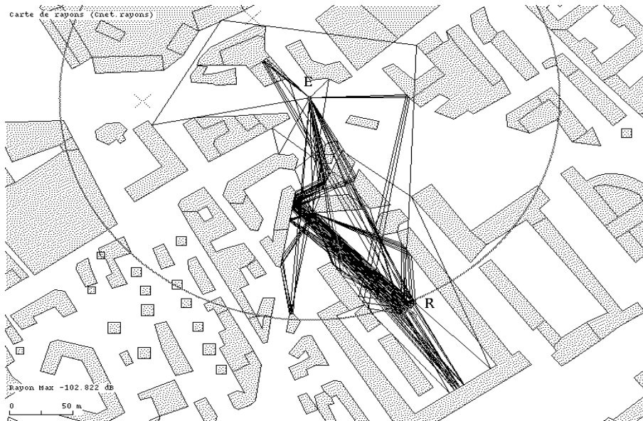
Figure 10 : Rayons diffractés et réfléchis entre un émetteur (E) et un récepteur (R) (modèle rayon)
